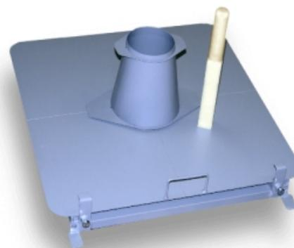
После наполнения с помощью уплотняющего бруса срезают излишек массы вровень с краями формы, поверхность стола очищают от остатков смеси. Через 30 секунд с момента среза излишка смеси форму поднимают за ручки вертикально вверх.
