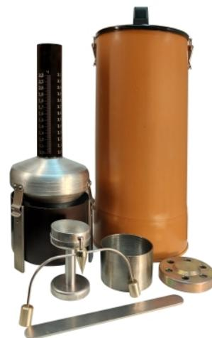
Прибор основан на принципе гидростатического взвешивания. Основные части прибора - поплавок и сосуд; вспомогательные - режущее кольцо(внутренний объем равен 200 см<sup>3</sup>) с крышкой, стальной нож(шпатель) и ведро-футляр с крышкой.
