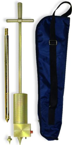
Коэффициент уплотнения грунта оценивается по количеству ударов падающего груза, необходимых для погружения конуса на глубину с 20см до 30см. Используются данные испытаний и таблицы(графики) в приложениях к паспорту прибора.
